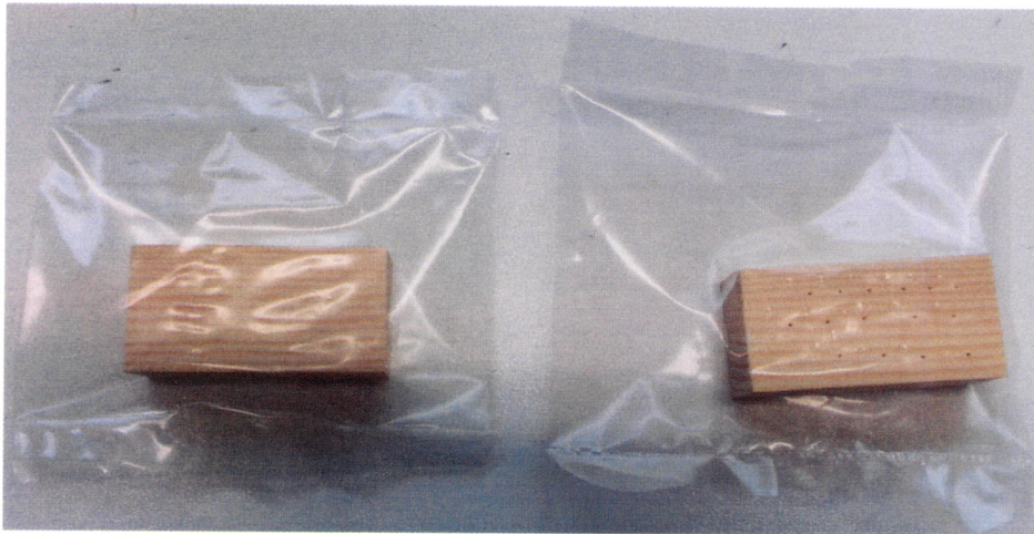
Abb. 01: Holzprüfkörper aus Kiefernspint eingeschweißt in Materialprobe (LDPE Folie). Rechte Probe durch feine Nadelstiche vorperforiert.
