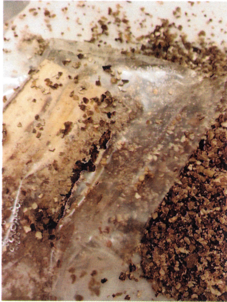
Abbildung 03: Beispiel der Penetration der Materialprobe LDPE Folie ohne Termitenschutz und Fraßschäden am Holzprüfkörper durch Coptotermes formosanus Fig. 03: Example of penetration of product type LDPE film without Anti-termite and damage of wooden test specimen by Coptotermes formosanus .
